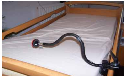
Wangentaster mit flexibler Halterung, sensitiv Artikel: 0060598
